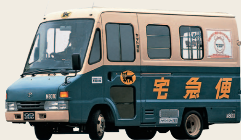
1999年に安全性の向上を目的にフルモデルチェンジしたウォークスルー車
